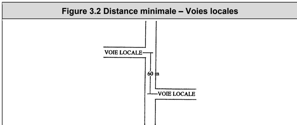
Dans le cas où l'une des voies de circulation est une voie collectrice ou une voie desservant des emplacements industriels, l'écart entre la première et la seconde voie de circulation ne doit pas être inférieur à cent (100) mètres.
